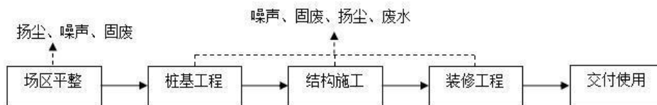
图2-2 施工期流程图 (单位: m³/a)
